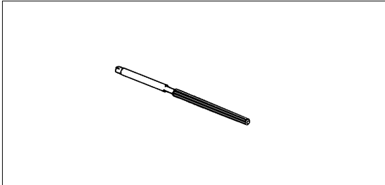
Piston Pin Puller Adapter : 57001-1211
